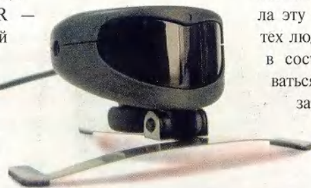
Устройство TrackIR дает возможность управлять экранным указателем легким движением головы
